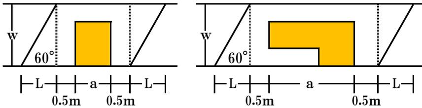
ただし、道路幅員3.0m以上、4.2m以下で掘削延長が20.0mを超える（ $a > 20.0\text{m}$ ）場合は半面復旧も可能とする。
