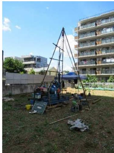
標準貫入試験(地盤の硬さを調べる試験)で使用するハンマー(「おもり」のこと:63.5kg)
