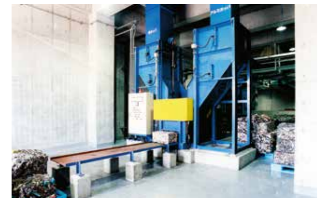
プレス機 選別した鉄類とアルミを、それぞれ圧縮してコンパクトな塊にします。
