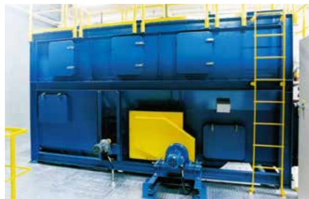
破碎物用磁選機 磁石によって破碎物から鉄分を選別します。
