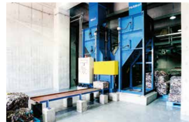
プレス機 選別した鉄類とアルミを、それぞれ圧縮してコンパクトな塊にします。
