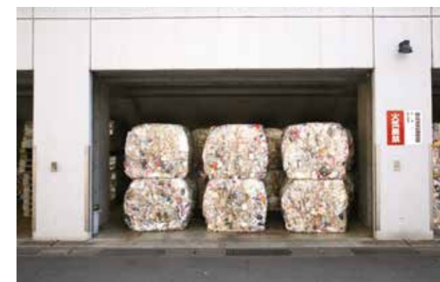
プラスチック減容物ヤード 圧縮梱包機でバール化された容器包装プラスチックを一時保管します。
