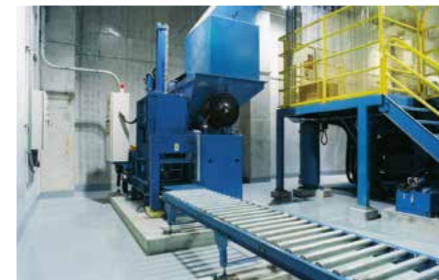
圧縮梱包機② (PETボトル用) PETボトルを圧縮梱包し、再資源化します。
