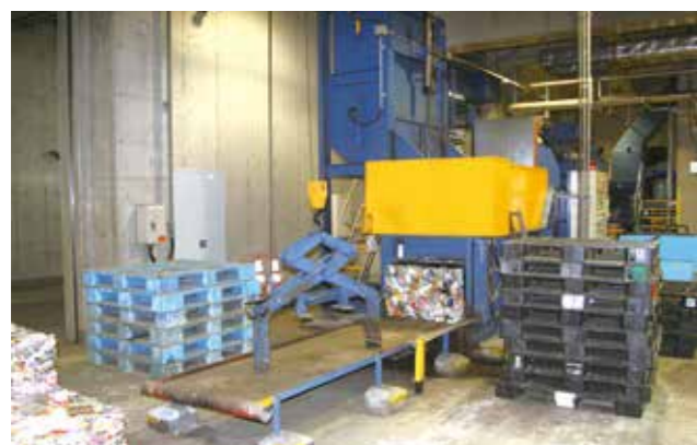
スチール缶プレス機 スチール缶を圧縮してコンパクトな塊にして再資源化します。
