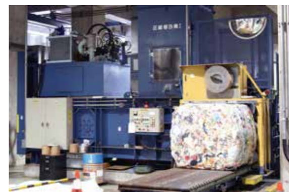
圧縮梱包機① (容器包装プラスチック用) 圧縮減容して再資源化します。
