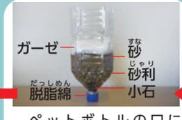
ペットボトルの口に脱脂綿を詰めてふさぐ。その上に①小石→②砂利→(あれば)③活性炭の順に入れていき、最後にガーゼをかぶせる。
