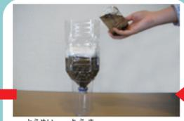
透明な容器の上にペットボトルをセットし、汚れた水をゆっくりろ過装置の上から注いでみよう!
