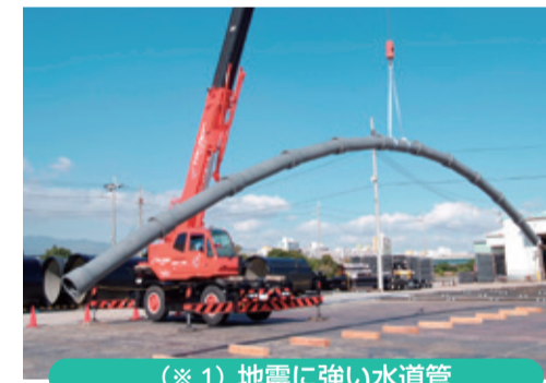
(※1) 地震に強い水道管 ©日本ダクト鉄管協会
