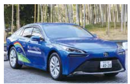
燃料電池自動車 (水素と酸素で電気を作って走ります)
